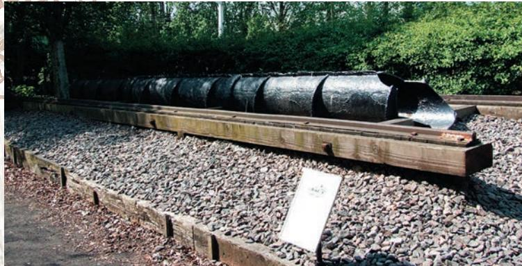
■ Современная реконструкция подвагонной пневмосистемы South Devon Railway, разработанной Изамбардом Брюнелем и братьями Сэмьюда
