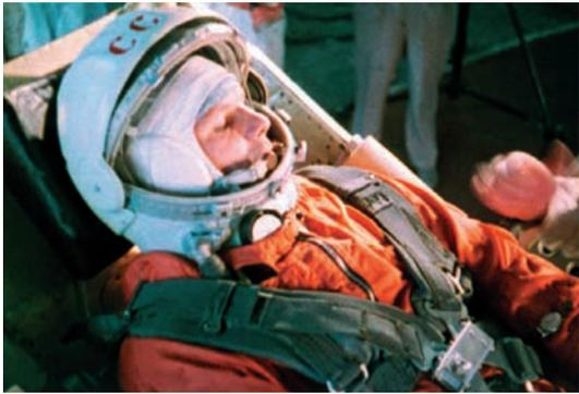
Скафандр, получивший обозначение СК-1, был основан на высотном костюме «Воркута», который предназначался для пилотов истребителя-перехватчика Су-9. Только шлем пришлось полностью переделать. В нём был установлен специальный механизм, управляемый датчиком давления: если оно резко падало, механизм мгновенно захлопывал прозрачное забрало.
