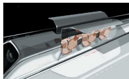
ственного транспорта, именуемого Hyperloop («Гиперпетля»). Hyperloop представляет собой интересный гибрид пневмопочты и маглева — поезда на магнитной подушке. Пассажиры будут перемещаться в специальных герметичных капсулах с салоном на 28 человек по трубопроводу с низким давлением. Сами трубопроводы будут размещены на эстакадах.
